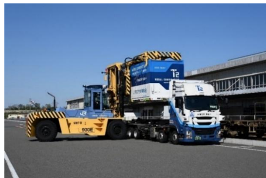
T2 のトラックへ共用コンテナを積み替える様子
